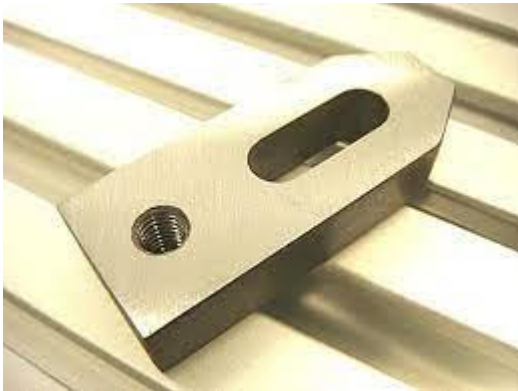
Figura 1. a) Brida de sujeción b) Prensa mecánica.
