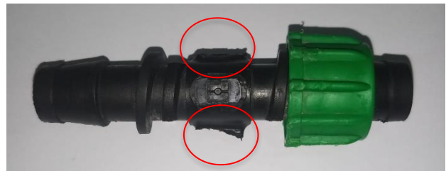
Imagen 2. Cople de \varnothing 5/8 in cinta a cinta.
