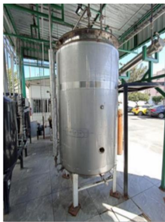
Figura 1. Reactor con enchaquetado de Dimple Jacket del Laboratorio Nacional de Desarrollo y Aseguramiento de la Calidad del Biocombustibles, LaNDACBio IPN.
