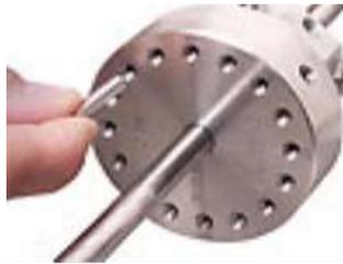
**Figura 6.** Disco inercial para balanceo de rotores.
