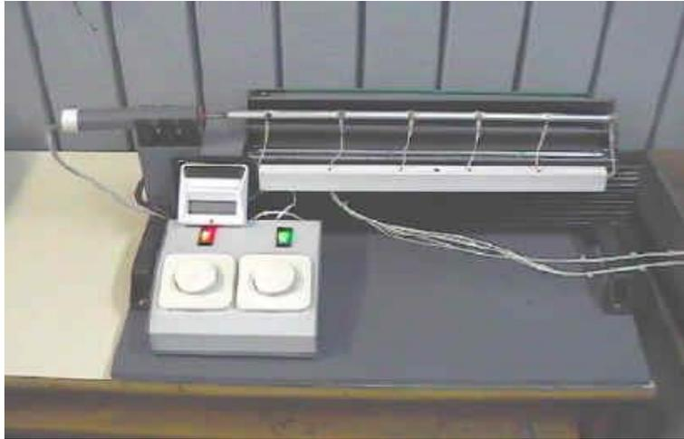
Figura 1.1 Disipador de Calor a través de Aletas [2]
