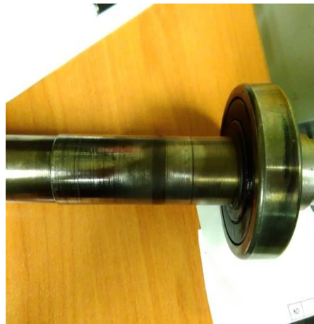
Figura 2. Surcos formados en la flecha
